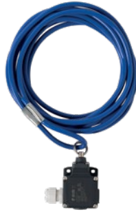
Выключатель с тяговым шнуром с тросом Возможен монтаж в вертикальном или горизонтальном положении, отлитый под давлением алюминиевый корпус, IP 65, длина шнура 4 м
