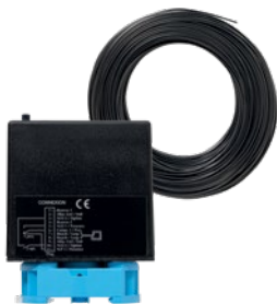
Индукционная петля Детектор индукционной петли с замыкающим контактом и переключающим контактом, может быть настроен на импульсный контакт или контакт длительного включения, с распознаванием направления, петлевой кабель 50 м
